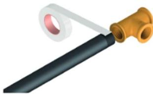
Dichten Sie das aufgeraute Außengewinde mit einem entsprechenden Dichtmittel ein, (Hanf wird nicht empfohlen) um die gewünschte Dichtheit der Rohrverbindung zu erreichen.
