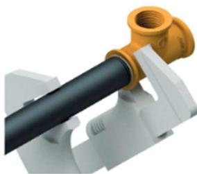
Drehen Sie nun das Gewinde in das Fitting ein. Das Gewinde darf nicht überdreht werden. Bitte beachten Sie die Einschraubtiefe und schrauben Sie das Außengewinde nicht tiefer ein. Bitte verwenden Sie geeignetes Werkzeug und Arbeitsweisen, um Verformungen an dem Fitting zu vermeiden.
