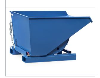
Selbstkipper müssen zum Entleeren nicht angehoben werden. Die leere Mulde geht selbsttätig in die Beladestellung zurück. Robuste Schweißkonstruktion aus 3-mm-Stahlblech, Lackierung blau RAL 5007. Serienmäßig mit Staplertaschen, Abrollsicherung und Kippverriegelung, Gliederkette als Abrutsch- und Kippsicherung. Zugseil zur Kippauslösung vom Staplersitz aus. Zusatz "A" bedeutet mit Ablasshahn und Sieb zum Trennen von Flüssigkeiten und Feststoffen.
