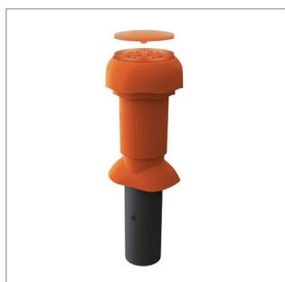
Die aerodynamisch optimierte Entlüftung des Venduct® Raumentlüfters durch Rohrgeometrie, Luftleitung und Regenhaube reduziert Verwirbelungen auf ein Minimum und stellt eine effektive Abluftleistung insbesondere bei ventilatorunterstützter Abluft sicher. Anfallendes Kondensat wird mittels einer Kondensattrinne sicher auf die Außenseite oberhalb der Dacheindeckung abgeführt.
